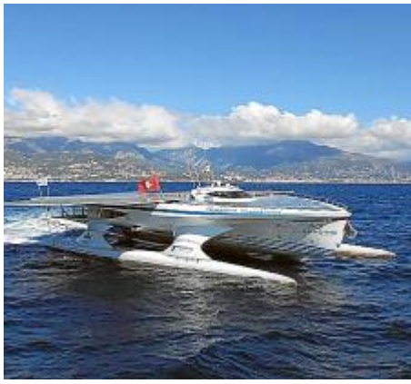
Капитан корабля Эрик Дюмон за штурвалом: 85-тонный катамаран работает на солнечных батареях, его максимальная скорость – 18,5 км/ч. Фото: А. Полетаев, П. Лосано, Planet Solar
